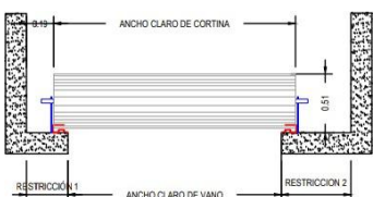
VISTA EN PLANTA MONTAJE EN CONCRETO
