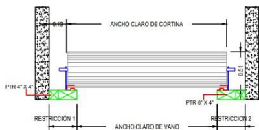
VISTA EN PLANTA MONTAJE EN ACERO
