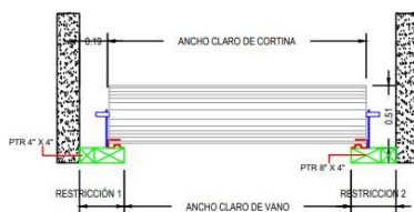
VISTA EN PLANTA MONTAJE EN ACERO
