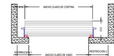
VISTA EN PLANTA MONTAJE EN CONCRETO
