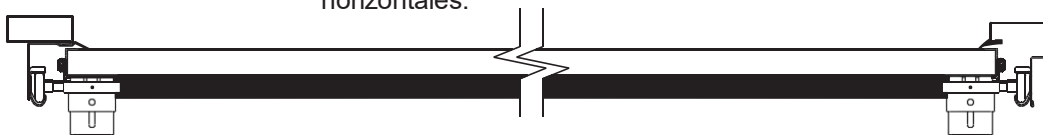
Fig. 4- Vista de la puerta en planta. Ejemplo de guía con tubo en la mano izquierda. Ejemplo de guía de perfil en la mano derecha.
